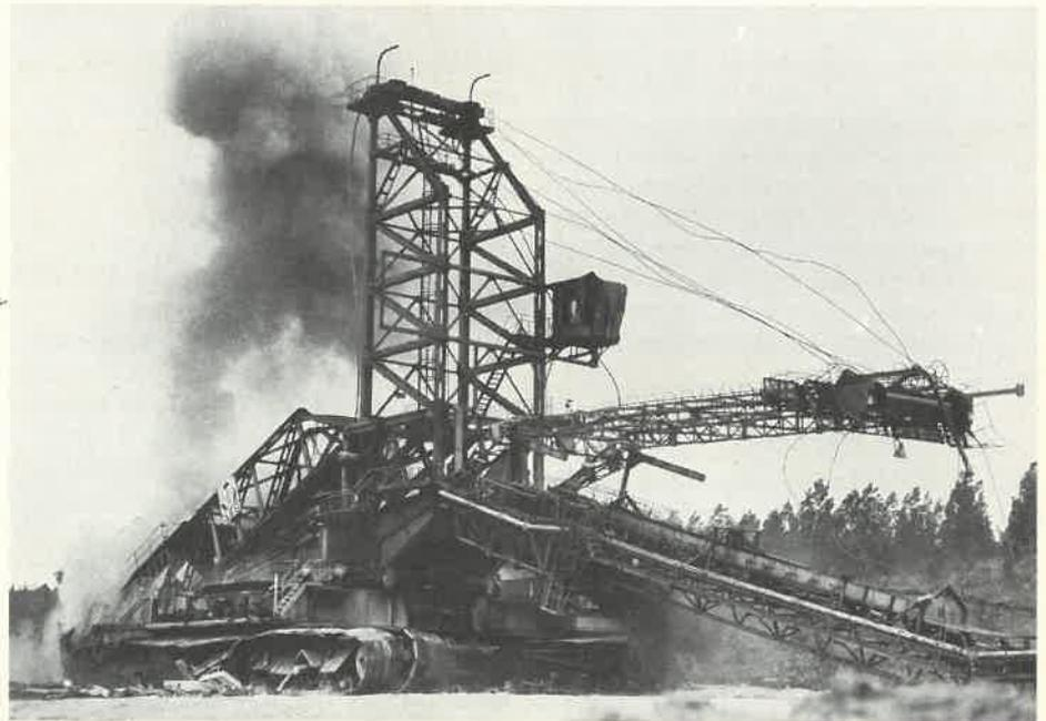
1 800 auf 2 800 m<sup>3</sup> je Stunde. Mit einem Dienstgewicht von 800 t, einer Ausleger-Ausladung von 60 m und einer Gesamthöhe von 26 m ging das Gerät unter der neuen Bezeichnung „Absetzer 748“ auf der Innenkippe des Tagebaus Frechen am 21. Mai 1962 wieder in Betrieb.
